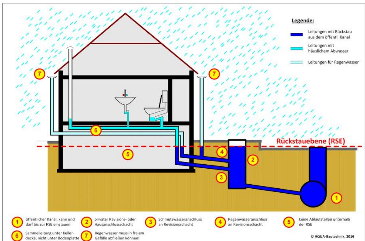
Für Gebäude ohne Keller stellt diese Situation in den meisten Fällen den Normalfall dar. Ein Rückstauschutz wird bei diesen Gebäuden erst dann erforderlich, wenn der Erdgeschossfußboden unterhalb der Rückstaebeine liegt.
