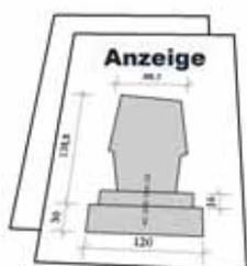
Bestandteil der Anzeige der sicherheitsrelevanten Daten ist die zeichnerische Darstellung der zu erstellenden Grabmalanlage mit den Angaben der Materialkennwerten, Befestigungsmitteln und Abmessungen. So sind in der Anzeige folgende Angaben zu Bauteilen, soweit sie vorhanden sind, zu machen:
